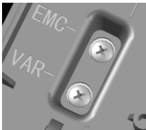
塑壳机箱限位螺钉示意图
