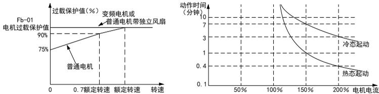
☐ 电机过载保护以后，需等待一段时间使电机冷却后才能继续运行。
