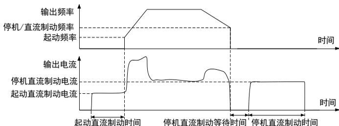
⚠️ **注意:** 对于高速或者大惯量的负载的起动, 不宜采取先长时间直流制动再起的方式, 建议使用跟踪起动方式。
