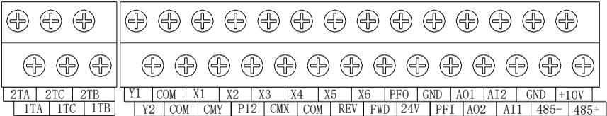
SB70系列690V级单机机型及SB70系列大功率并联机型控制板端子排列（建议使用1mm 的铜导线）：
