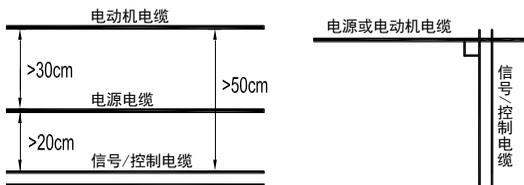
电机电缆越长或者电机电缆横截面积越大时，对地电容就越大，干扰相互耦合也越强，应该使用规定截面积的电缆，并尽量减小长度。
