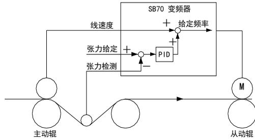
**加减速斜坡后的给定频率修正：**PID 输出叠加在加减速斜坡后的给定频率上，与“加减速斜坡前的给定频率修正”的方法相比，可以在加减速过程中也起修正作用。
