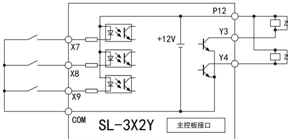
数字I/O扩展板提供多路数字输入输出量，可由用户定制。例如：5路数字输入型（SL-5X）、5路数字输出型（SL-5Y）、3路数字输入2路数字输出型（SL-3X2Y）等。以SL-3X2Y为例，功能及规格如下：
