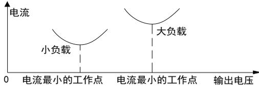
☐ 自动节能运行仅对 V/F 控制方式有效，并且只适用于负载平稳的场合。
