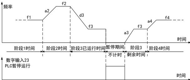
数字输入 22 “PLC 控制禁止”有效时，转入低优先级的运行方式（详见 57 页 F0-01 的说明）；无效时，PLC 恢复运行。
