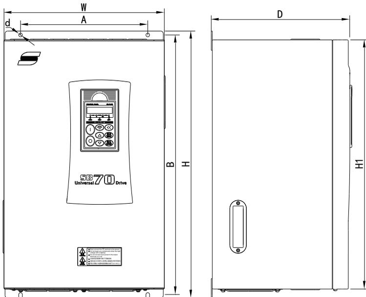
SB70G400T4及以上、SB70G355T6C及以上功率等级柜式单机机型外形图如下：
