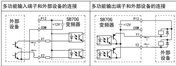
SB70系列220V、380V级单机机型多功能输入端子及输出端子有漏型逻辑和源型逻辑两种方式可供选择，接口方式非常灵活、方便，对应的典型接线方式如下：
