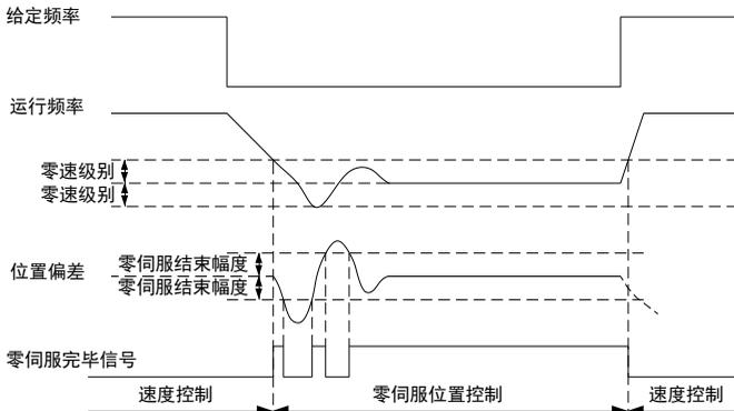
☐ 零伺服只能使用正交编码器，F9-22 “零伺服结束幅度” 中的脉冲数是指正交编码器 A、B 两相信号所有边沿（上升、下降沿）的个数。
