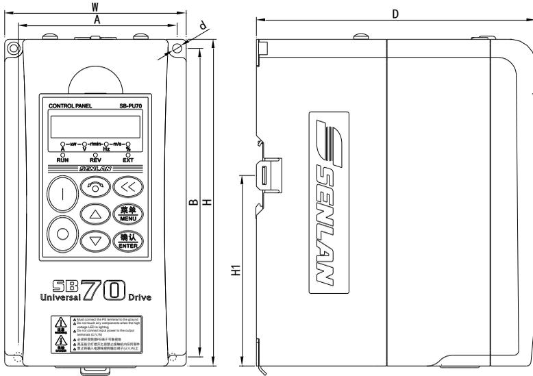
SB70G4T2、SB70G5.5T2、SB70G5.5T4~SB70G15T4挂机单机机型外形图如下：
