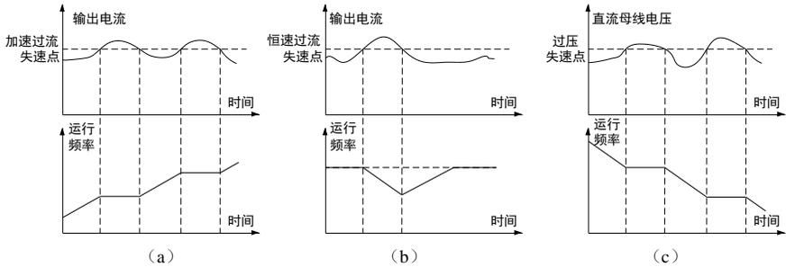
如果实际运行中失速持续时间超过 1min，变频器会出现“Er.Abb 异常停机故障”，可选择“2：有效，无限时”屏蔽此故障。
