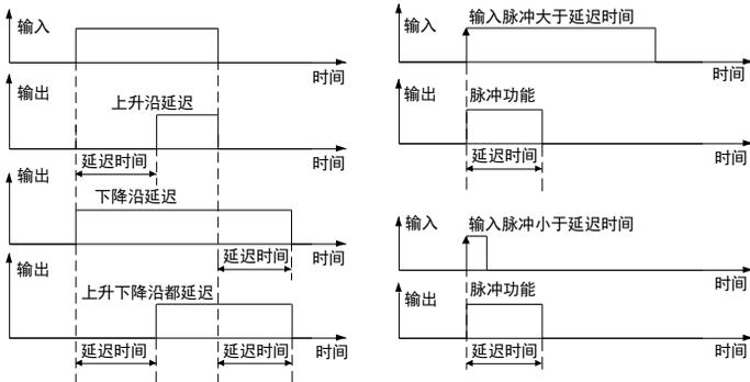
☐ 用定时器可以完成信号的消抖，例如上升沿延迟功能，当输入脉冲小于延迟时间时无输出。
