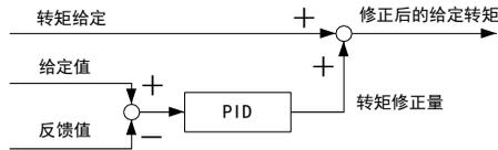
自由 PID 功能：将 PID 作为可编程模块，输入、输出可单独定义，PID 输出可连接到模拟输出等。
