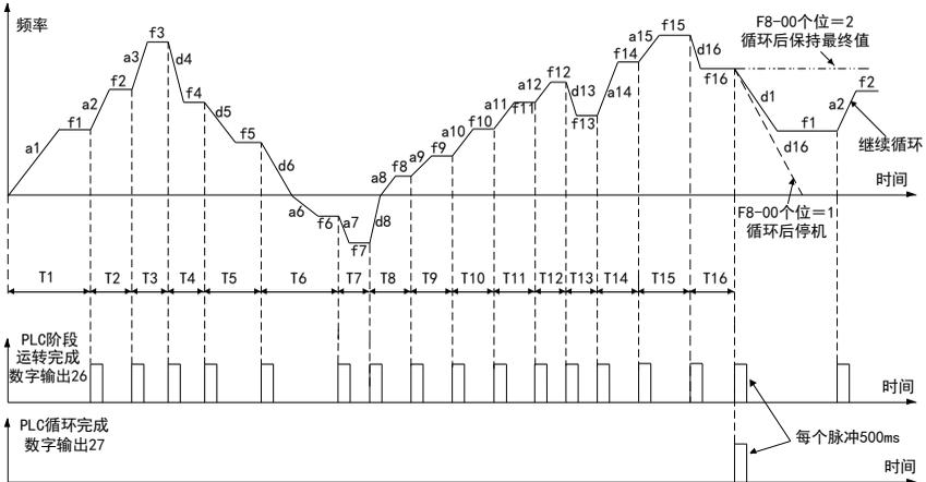
数字输入 23 “PLC 暂停运行”有效时，PLC 暂停运行；无效时恢复暂停前的阶段运行（起动方式由 F1-19 确定），如下图：
