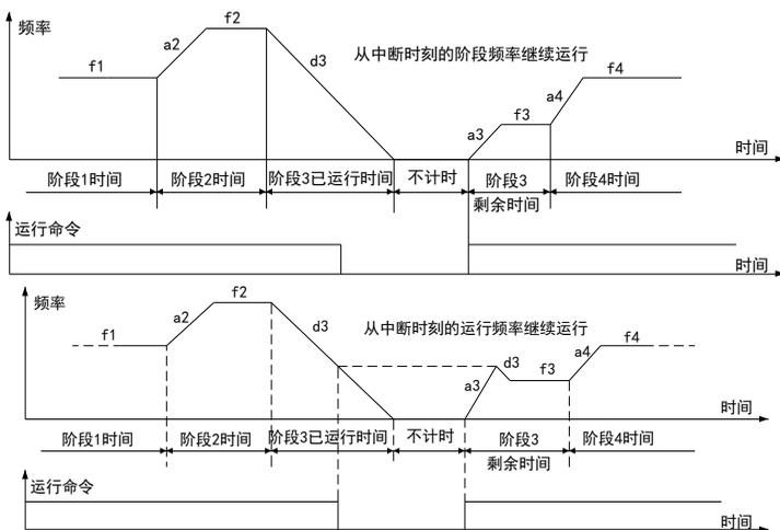
☐ PLC 状态可选择掉电存储，这样下次再运转时，可从停止时的状态继续运行。例如：一天的作业结束后，变频器停止并断电，第二天只需上电并起动运行，就可继续前一天未完的作业。
