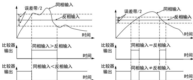
变频器可用两个信号比较的结果当作变频器保护动作的触发信号，通过“比较器配置”的百位选择需要的保护动作。
