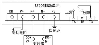
制动单元和变频器、制动单元和制动电阻之间的接线应在5m以内，并且使包围回路面积最小。
