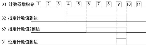
📖 F9-16 “计数器分频系数”：对输入的脉冲合并后进行计数，由 F9-16 个脉冲合并为 1 个计数脉冲。
